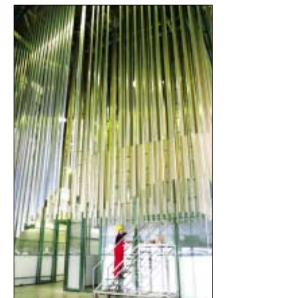
Κάθετη Ηλεκτροστατική Βαφή. Vertical Electrostatic Painting.
