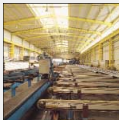
Τραπέζι Διέλασης 2200 τόνων. Extrusion Table of 2200 tones.
